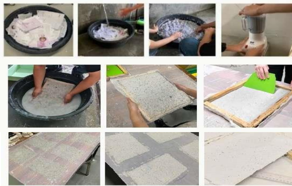
Gambar 4. Proses pembuatan kertas daur ulang kedua yang berhasil Sumber : Angeline Victoria Hartanto (2021)
