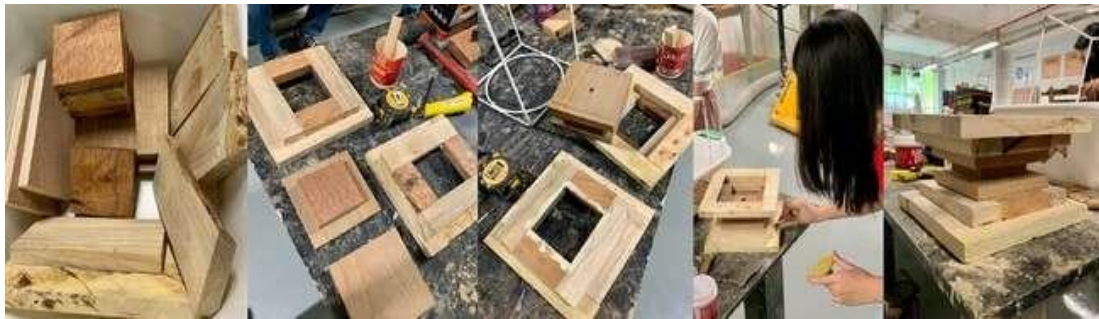
Gambar 6. Proses pembuatan alas lampu dari potongan kayu sisa industri Sumber : Angeline Victoria Hartanto (2021)
